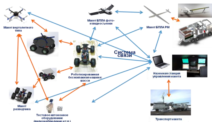
Рис. 2. Система управления множеством единиц подвижного состава на основе роевых технологий
